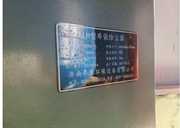
布袋除尘器铭牌
